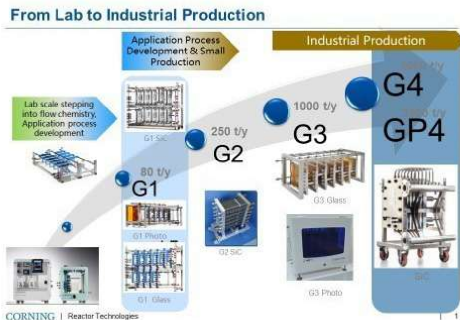
Figure 13 : Présentation des différentes étapes d'intégration de méso-réacteur d'un laboratoire à une production industrielle
