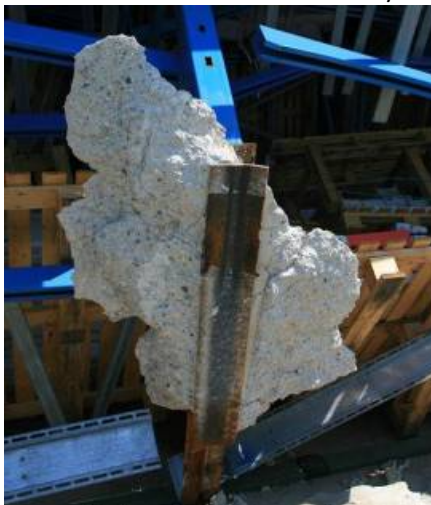
d/ Arrachement de la poutre support
