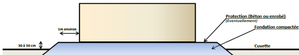
Figure 1-5 : Assise simple en remblai compacté
