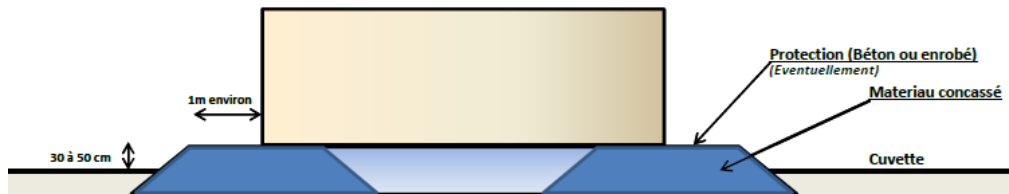
Figure 1-6 : Assise simple en remblai compacté avec anneau en matériau concassé
