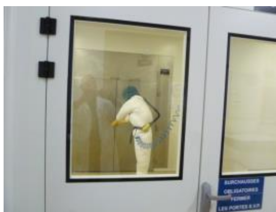
Etuve en salle fermée avec opérateur en tenue de travail équipée de d'EPI (combinaison tyvek, gants, cagoules avec introduction d'air ventilé).
