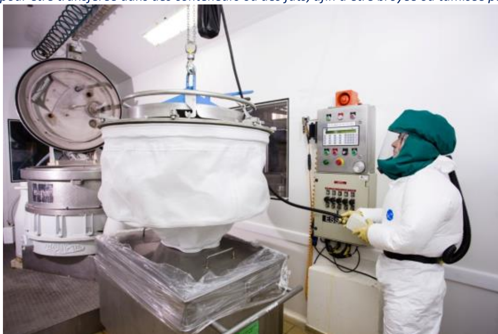
Essoreuse en salle fermée avec opérateur en tenue de travail équipée de d'EPI (combinaison tyvek, gants, cagoule avec introduction d'air ventilé).
