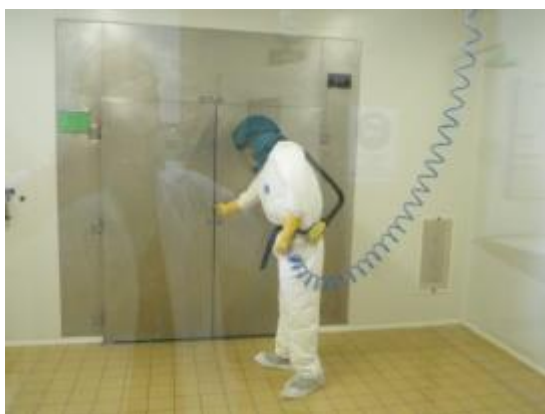
Etuve en salle fermée avec opérateur en tenue de travail équipée de d'EPI (combinaison tyvek, gants, cagoules avec introduction d'air ventilé).
