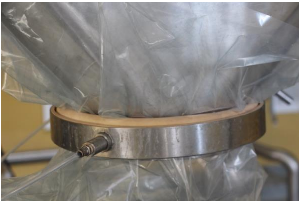
Etanchéité assurée par un joint gonflant
